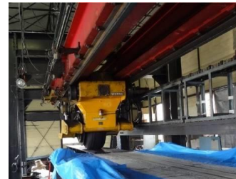
床版: 輪荷重走行試験
