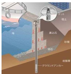
■アンカーによる港湾の岸壁補強
