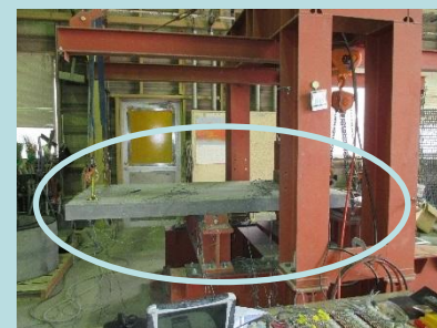
ESCONデッキ(覆工板)
