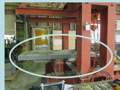
ESCONデッキ(覆工板)
