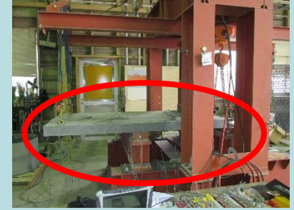
ESCONデッキ(覆工板)
