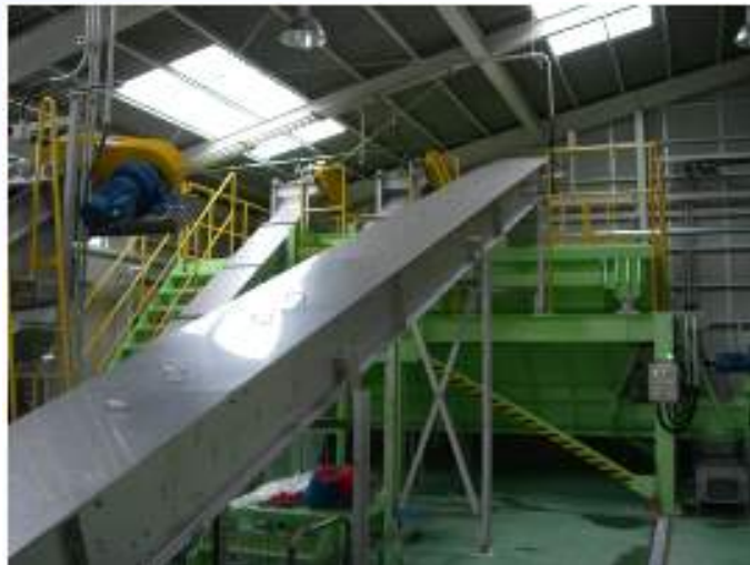
食品廃棄物飼料化プラント(写真右が減圧乾燥機)
