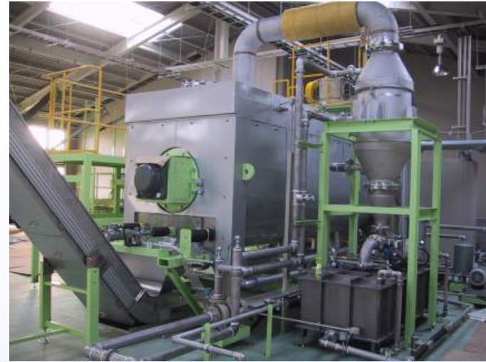
食品廃棄物飼料化プラント(写真右が減圧乾燥機)
